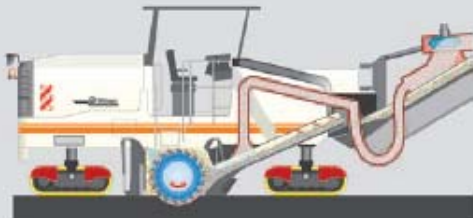
3. 切削面に接触すると W200 は平行を維持しながらゆっくりと下げられます
