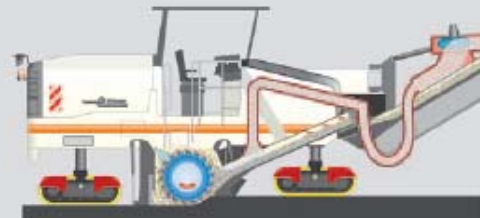
4. W200 は切削開始から直ちに最大作業深さの切削が可能です
