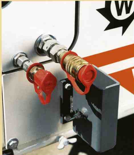
油圧ハンマーへの接続が容易に出来ます。
