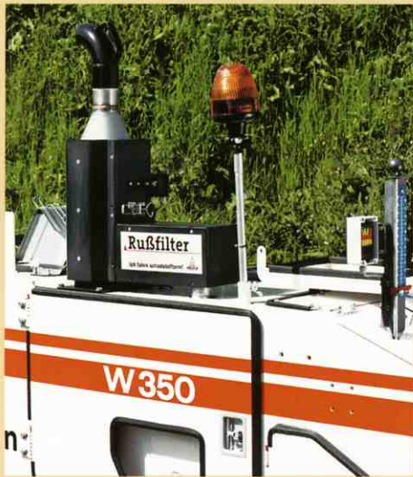
きれいな排気ガスのためにばい煙フィルターが粒子の排出を90%抑えます。
