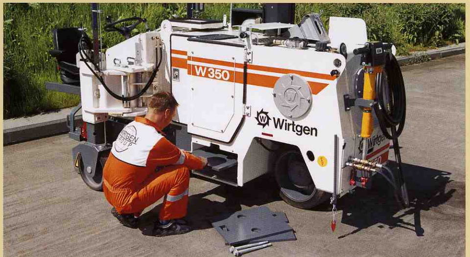
ビル内での作業のために作業重量を1.35トン減らすことができます。バラストは一人で簡単に取り外し可能です。
